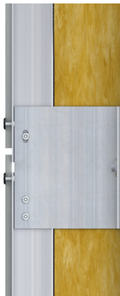
Dolt profilstöd med kombinationsförbindelse på en väghållare
