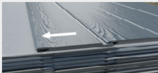
Hardie® VL Plank br.dor levereras "instuckna" i varandra. Fasadbrädorna ska därför först dras ut i sidled innan de kan lyftas av pallen.
