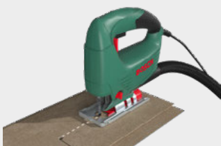
Vid beskärning av hörn ska förborring av ett hål på minst 8 mm utföras i hörnet för att förhindra att brädan går av
