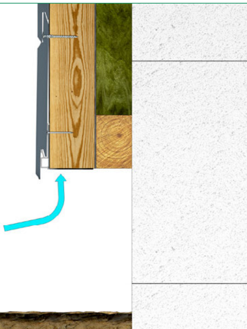
Säkerställ korrekt ventilation bakom fasaden genom att montera ventilationsprofiler.
