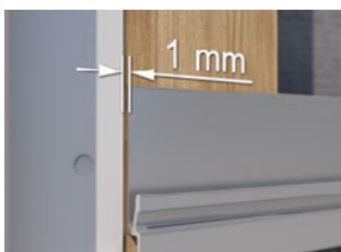
Infästning av startprofilen mot dubbel-J hörnprofilen.
