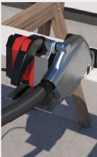
Vid användning av Hardie™ Blade-sågklinga kräver de flesta cirkelsågar att brädornas målade yta är nedåtriktad. Vi rekommenderar att detta kontrolleras före kapning.
